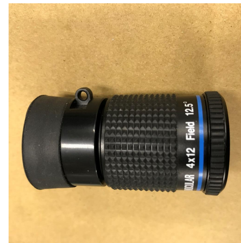
図2. NEITZ ポケビュー 遠方視用の倍率、レンズ口径、視野の表示
