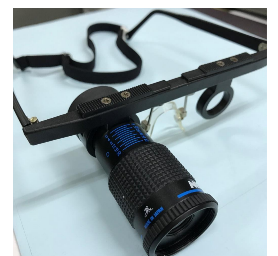
図6. フレームにPK-4を固定
