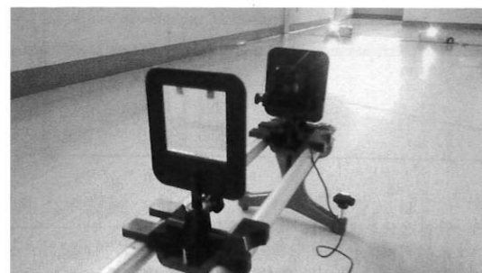
図5 目盛をつけたスクリーンを対物レンズ側に設置
