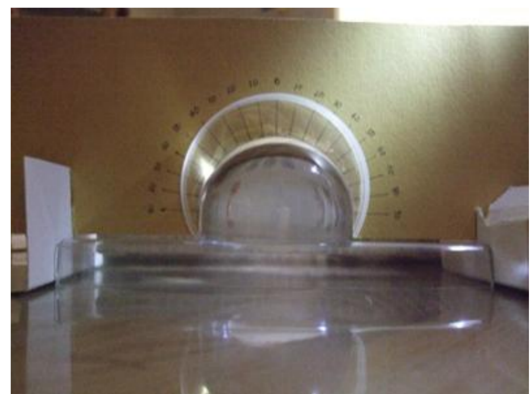
図9. 40度で入射した発光ダイオードの光が底面で反射し、焦点を結ぶ様子
