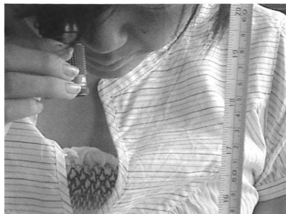
図4 単眼鏡による虚像位置の測定 左：卓上式拡大鏡から単眼鏡を離し、文字が見える位置にもっていく。 右：単眼鏡の対物レンズ頂点から文字までの距離を計測する。
