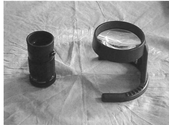
図2 卓上式拡大鏡の虚像距離を求めるために用いた機器
