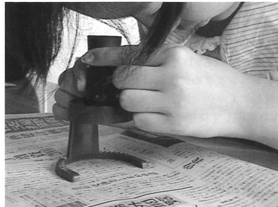
図3 単眼鏡による虚像位置の測定
