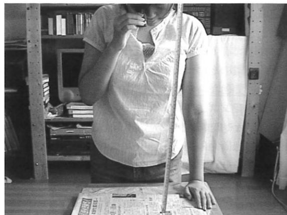
図4 単眼鏡による虚像位置の測定 左：卓上式拡大鏡から単眼鏡を離し、文字が見える位置にもっていく。 右：単眼鏡の対物レンズ頂点から文字までの距離を計測する。
