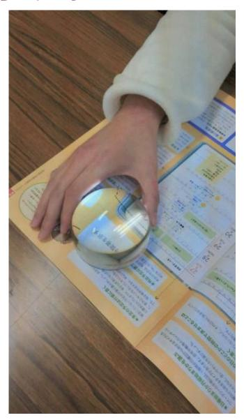
横倍率で表示 材質 屈折率 横倍率 ガラス 1.52 1.8倍 MR-8 1.60 2.0倍
